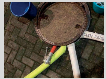
Gegquetschte Schläuche: Kapazitätsverlust und Beschädigung als Folge.
