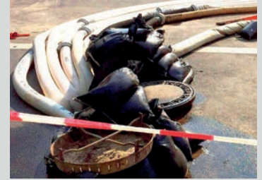
Gegquetschte Schläuche: Kapazitätsverlust und Beschädigung als Folge.
